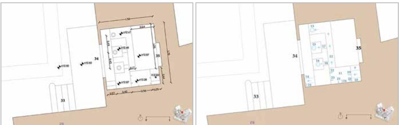
**Figura 4.-** Estado actual de la arca de distribución. (a) Dimensiones y cotas topográficas. (b) Hipótesis de su configuración. (7) Cañería nueva, (11) Arqueta de amortiguamiento, (12) Acequia de distribución, (13) Salida de agua, (14) Rebosadero, (15) y (16) Salida de agua con arqueta, (17) y (18) Conexión entre acequia y salida de agua, (19) hasta (23) Canalizaciones de plomo, (24) y (25) Llaves de paso, (28) Acequia Torre del Agua, (33) Escalera, (34) Puerta de acceso y (35) Puerta tapiada.
