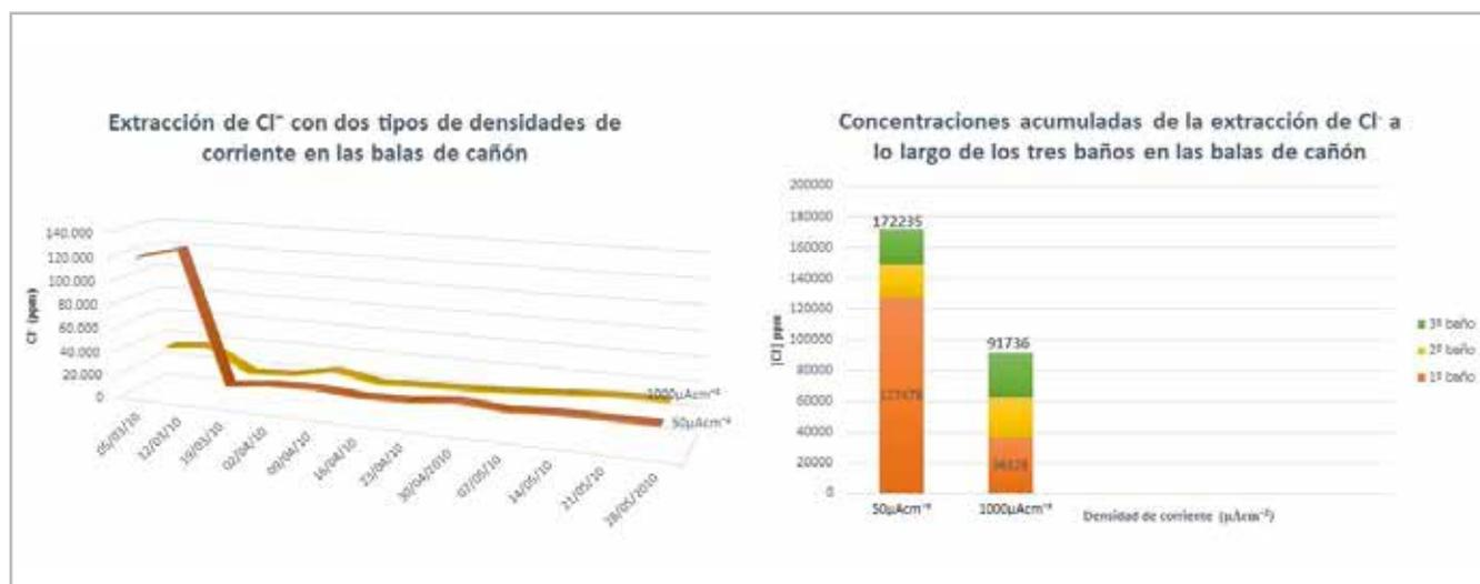
**Gráfico 1.-** Proceso de extracción de cloruros en las balas de cañón testadas.
