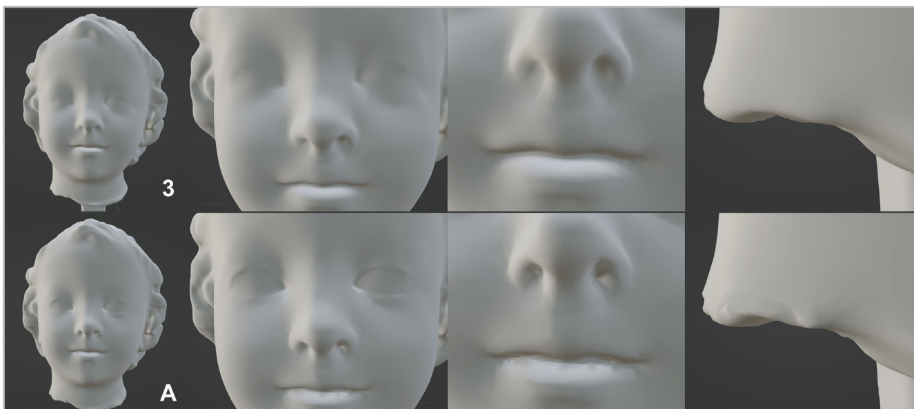
Figura 4.- Comparativa del resultado 3 (reducción por Quads Remesher® 1.2) y modelo A (reducción por diezmado junto con suavizado laplaciano).
