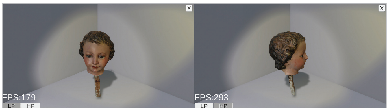
Figura 8.- Interfaz de la aplicación desarrollada con UNITY®2022 1.18. A la izquierda la visualización del modelo high-poly y a la derecha la visualización del modelo low-poly . En el contador FPS (fotogramas por segundo) se puede observar la diferencia en frecuencias de visualización entre ambos modelos.
