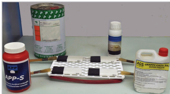
Figura 5.- Imágenes de la aplicación mediante brocha de los distintos tratamientos antigrafiti. Una parte de las probetas ha sido cubierta con cinta de color negro a fin de ser utilizada como zona de control de cara a evaluar los posibles cambios colorimétricos.
