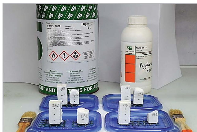
Figura 2.- Aplicación mediante brocha (probetas en primer término) y ascensión capilar (probetas en segundo término) de productos consolidantes en algunas de las probetas de mármol ensayadas (en este caso, alteradas superficialmente de manera inducida).
