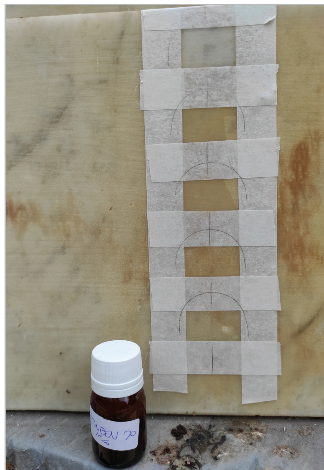
Figura 3.- Disposición de zonas de testado de limpieza.
