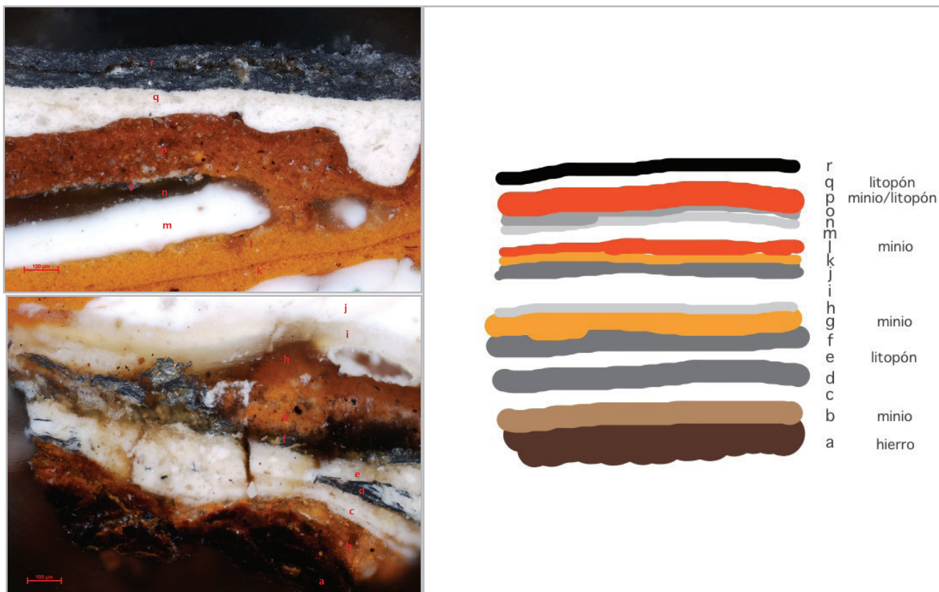
Figura 6.- Sección estratigráfica de la muestra M33-H1 mediante Microscopía Óptica con fuente de luz visible (izquierda) y esquema de estratos (derecha).
