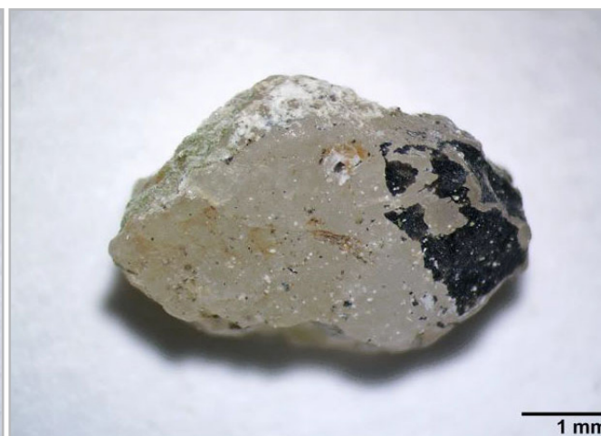
Figura 2.- Fotografías al microscopio estereoscópico (a la izquierda, pintura blanca; a la derecha, pintura negra). Fotografías procedentes del informe de Laboratorio Diagnostica per il restauro, Asesoramiento y Diagnóstico para la Conservación y la Restauración.
