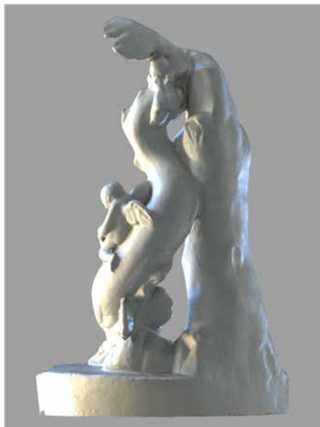
Figura 8. - Modelo 3D digitalizado con escáner de luz estructurada a través de un cristal de vitrina
