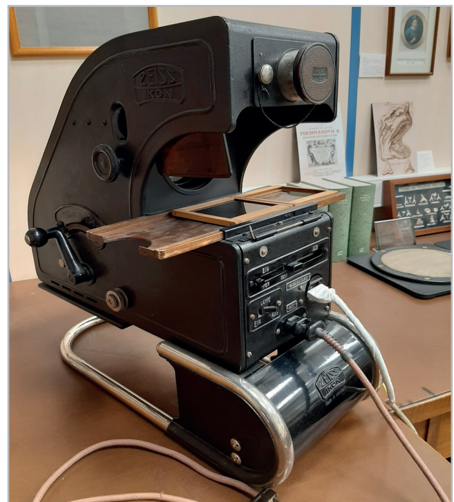
Figura 3.- Epidiascopio de D. Eduardo Hernández-Pacheco de tubo de acero (Museo de la Geología, UCM), primera versión del modelo "Lektor". Fotografía de: Laura Díaz Moreno. Se aprecia el cambio en la estructura inferior tomada a su vez del modelo "Adept" (1934).
