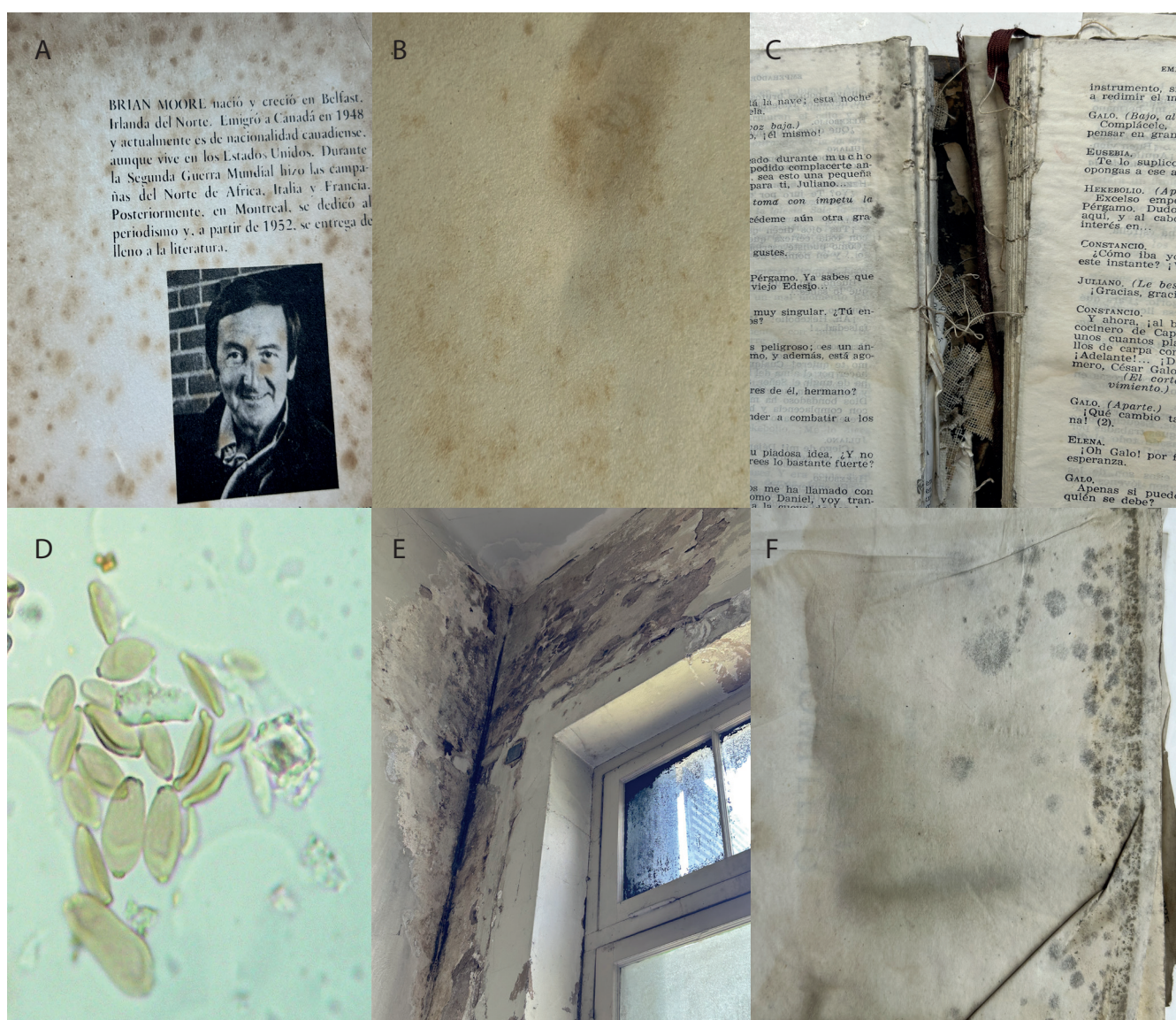
Figura 2.- Señales físicas del foxing en libros conservados en la biblioteca "Dr. A. Pérez Aznar, Senado de la Provincia de Buenos Aires, Argentina" y representación de los tres puntos propuestos en el Triángulo. Sustrato susceptible: [A, B, C] Ejemplares de la biblioteca con notorias manchas de foxing en el papel. Microorganismos: [D] Identificación in vitro de Cladosporium sp. en el papel. Entorno conductivo: [E] Sitio de guarda con marcada presencia de desarrollo de humedad. [F] Papel afectado por humedad con evidencia de foxing. Copyright: las imágenes han sido tomadas por los autores en una investigación previa (Nitiu et al. 2017).
