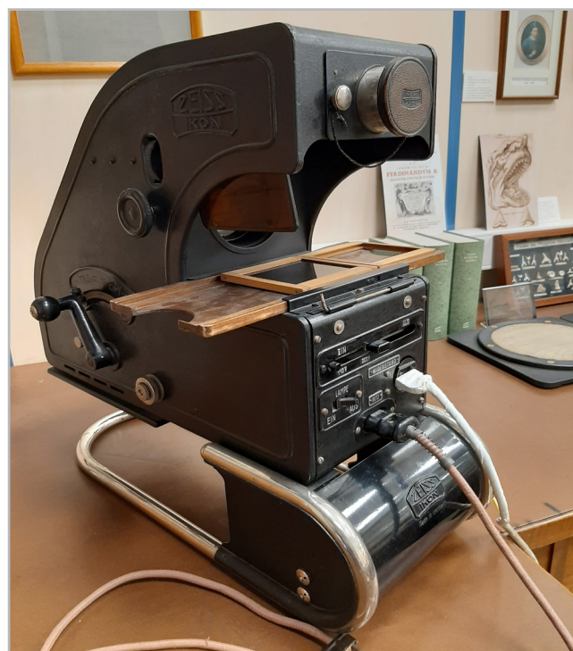
Figura 3.- Epidiascopio de D. Eduardo Hernández-Pacheco de tubo de acero (Museo de la Geología, UCM), primera versión del modelo "Lektor". Fotografía de: Laura Díaz Moreno. Se aprecia el cambio en la estructura inferior tomada a su vez del modelo "Adept" (1934).
