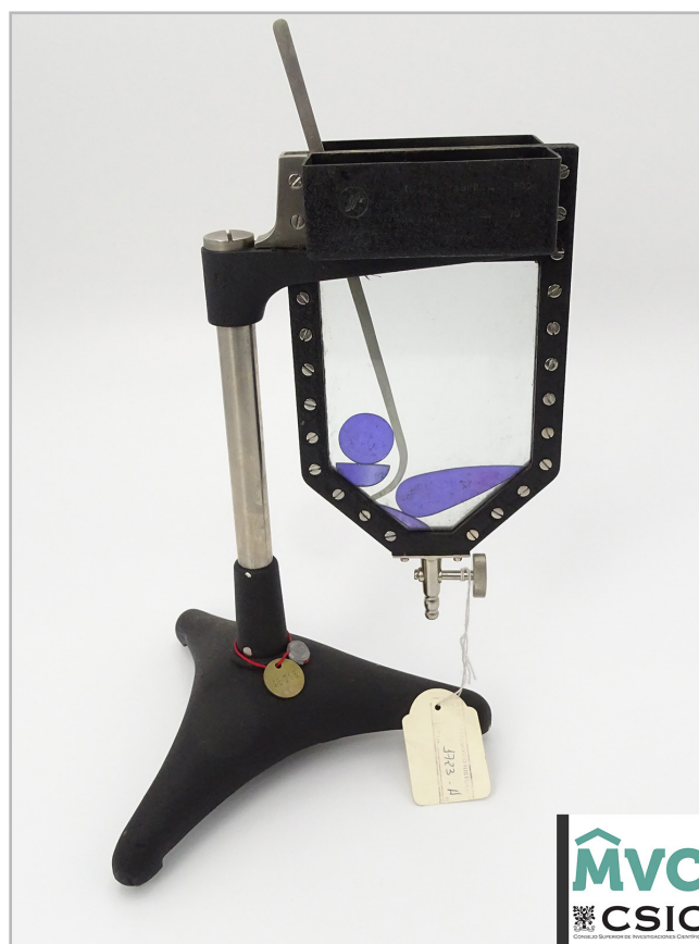
Figura 1.- “Aparato para corrientes líquidas” (1942). La introducción de agua por la parte superior refleja los distintos regímenes de fluido que se desplazan por el cristal según el obstáculo que se introduce en el interior. Fotografía de Esteban Moreno Gómez.
