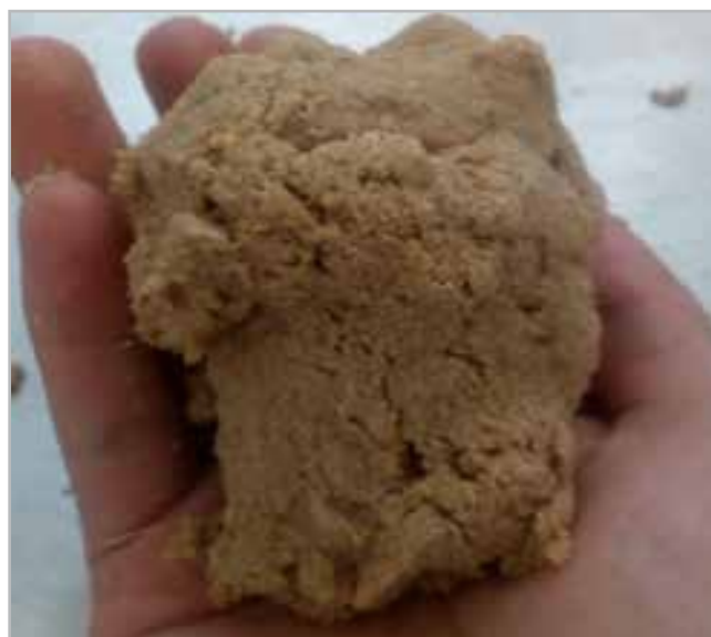
Figura 5.- Amasado de la pasta. Se observa la maleabilidad, la textura, la facilidad de modelado (Elaboración propia 2017)
