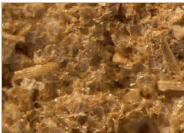
Figura 6.- Pasta vista al microscopio estereoscópico a 8x. Se ve la forma de las células del parénquima mezclado con la caña de maíz molida (Elaboración propia 2017)
