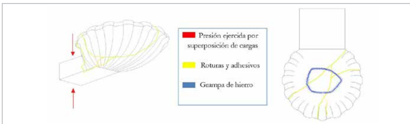
Figura 5.- Izquierda, esquema de disposición de cargas. Derecha, disposición de la abrazadera de hierro
